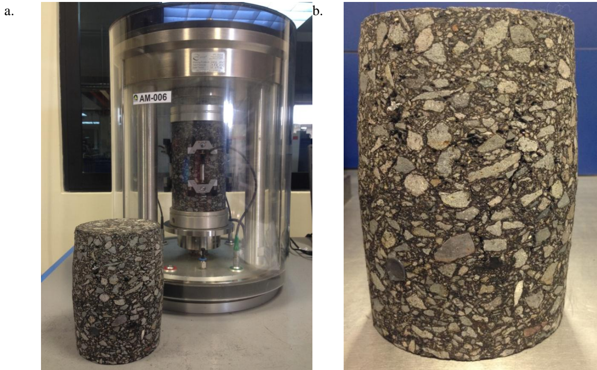
Figura 25. Ensayo de Creep Dinámico a. Asphalt Mixture Performance Tester AMPT b. Espécimen posterior a la falla.
