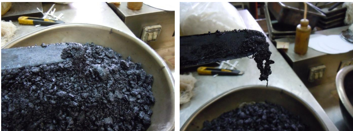
Figura 4. Mezcla mal homogenizada y formación de grumos
