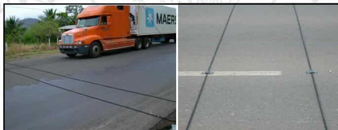
**Figura 5.** Cables y contadores automáticos en sitio.
