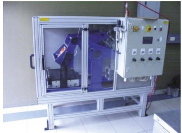
Figura 1. Equipo compactador de vigas
