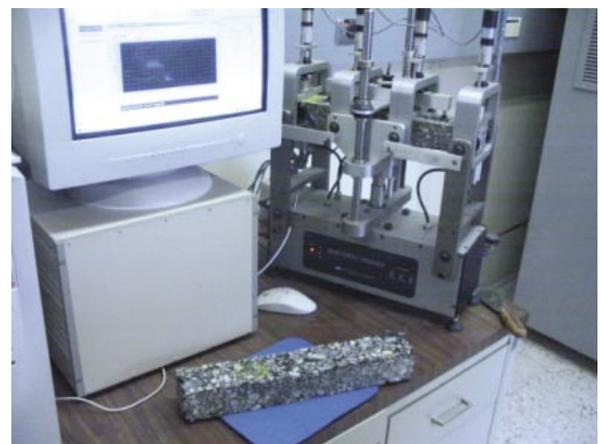
Figura 2. Equipo de fatiga en vigas para laboratorio
