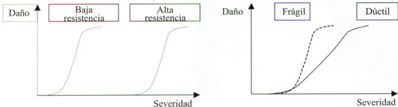
Figura 2: Curvas de fragilidad o relaciones entre severidad de amenaza y nivel de daño resultante
