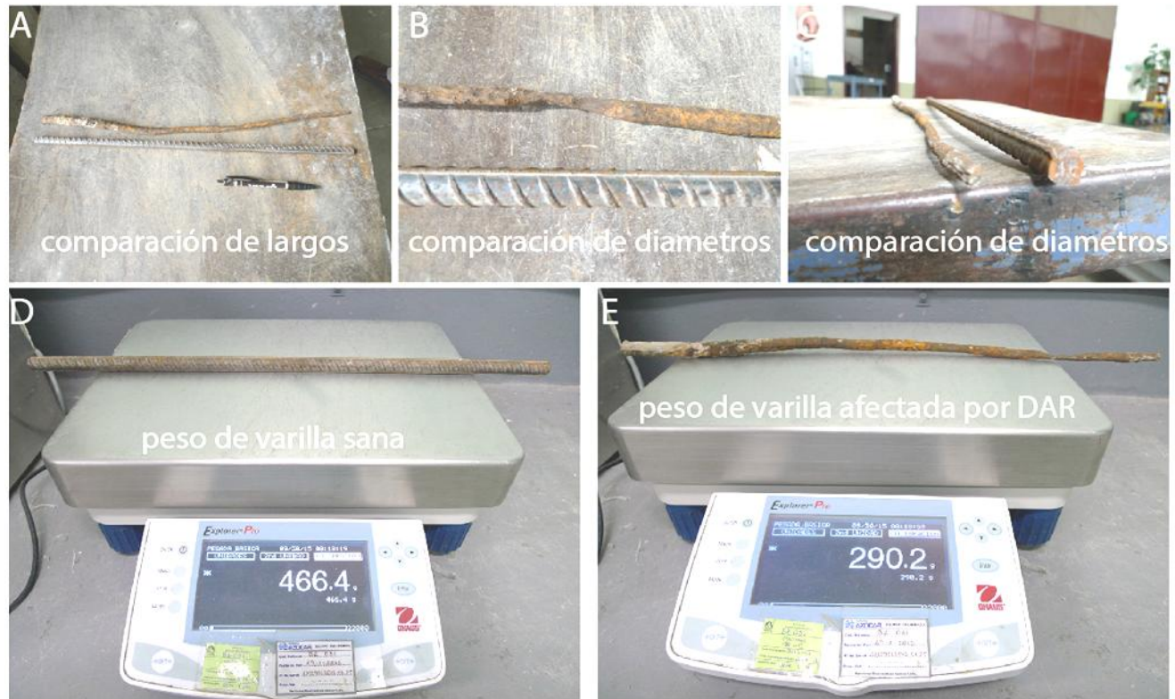
Figura 42. Varillas No.4 comparadas en el laboratorio. A) Ambas varillas miden 48,9 cm. B) y C) Comparación de los diámetros de las varillas. D) Pesaje de la varilla sin alteración. E) Pesaje de la varilla con alteración obtenida del km 38+600 de la RN 27.
