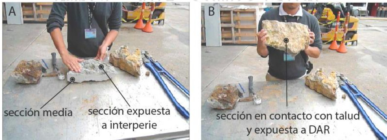
Figura 26. Bloque de concreto lanzado obtenido del talud del km 38+600 de la RN-27, se muestran las tres superficies sobre las cuales se realizó prueba de reacción del componente calcáreo del concreto con ácido clorhídrico. A) Lado expuesto a la intemperie y sección media. B) Se muestra la superficie del bloque que estuvo en contacto con los materiales originales del talud, los cuales que presentan DAR.
