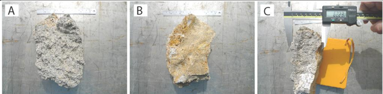
Figura 15. Muestra 1. A) Superficie externa. B) Superficie en contacto con el talud. C) Sección transversal.
