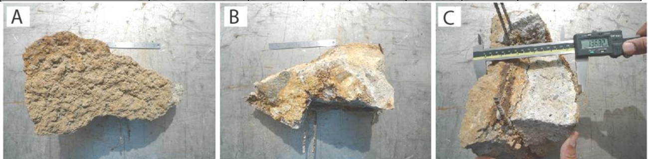
Figura 16. Muestra 2. A) Superficie externa. B) Superficie en contacto con el talud. C) Sección transversal.
