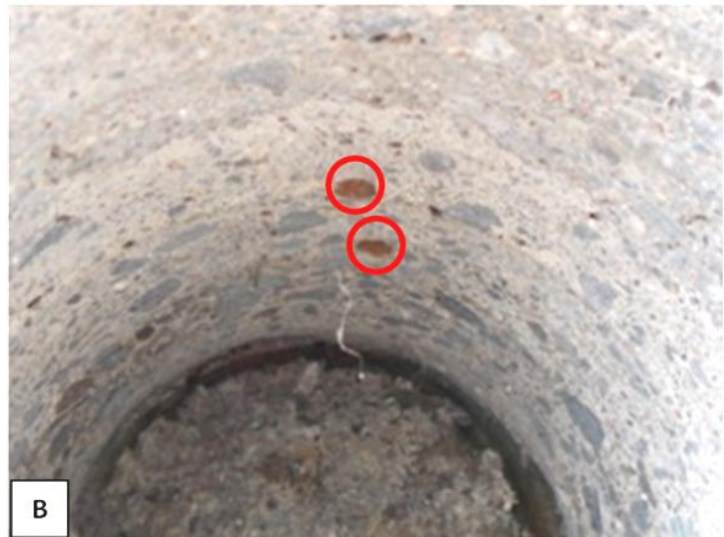
Figura 61. Sitio de extracción del núcleo No.9., km 44+230. A) Vista general del talud y del punto de la extracción. B) Interior de la perforación, se detalla el corte de las varillas que fueron extraídas como parte del núcleo de concreto.
