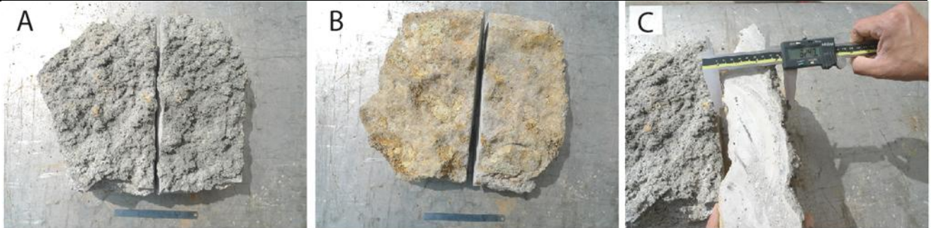
Figura 18. Muestra 4. A) Superficie externa. B) Superficie en contacto con el talud. C) Sección transversal.
