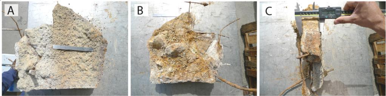
Figura 17. Muestra 3. A) Superficie externa. B) Superficie en contacto con el talud. C) Sección transversal.
