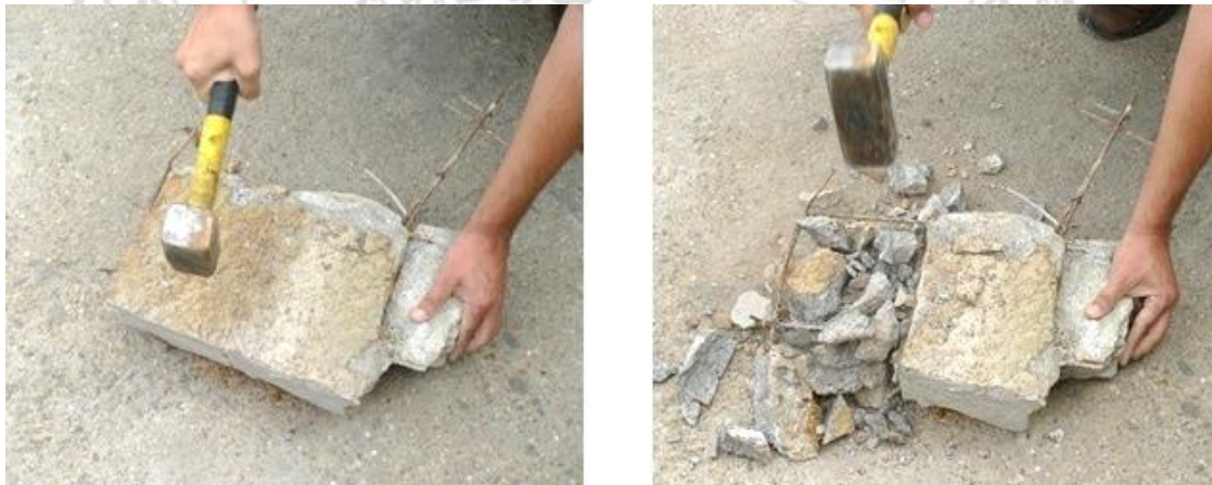
Figura 35. Separación en el laboratorio del refuerzo de acero.
