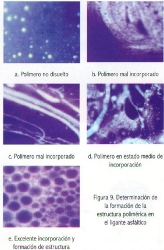
Figura 9. Determinación de la formación de la estructura polimérica en el ligante asfáltico
