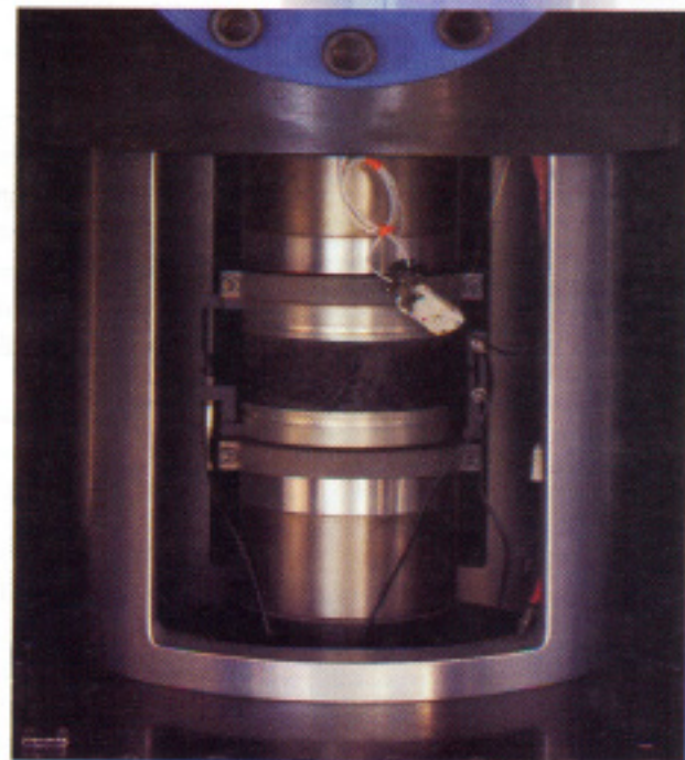
Figura 3: Dispositivo de cortante SUPERPAVE, montaje de espécimen de prueba.
