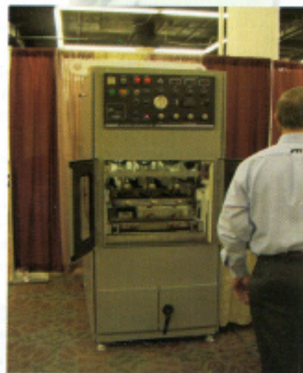
Figura 1: Dispositivo de ensayo en pista a escala de laboratorio. Analizador de Mezclas Asfálticas (APA).
