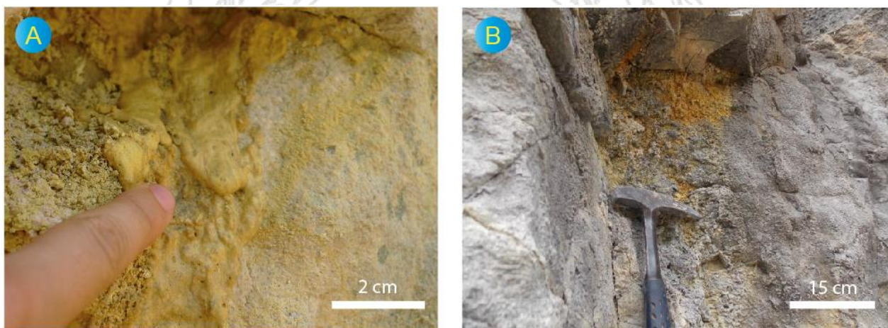
Figura 6. A) Afloramiento en estacionamiento (km 46 + 300), se muestra la presencia de azufre con una textura fluidal en primer plano pero también en forma de pseudoesferas o nódulos en la parte superior izquierda. B) Azufre en nódulos en afloramiento en estacionamiento (km 48+000). Este azufre posiblemente sea resultado de la oxidación del mineral pirita que también fue identificado en las rocas de estos sitios.
