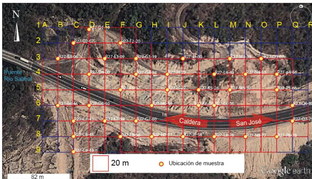
Figura 4. Imagen aérea tomada de Google Earth® con la ubicación del sitio de donde se tomaron las muestras de suelo en el estacionamiento 48 + 000.
