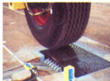
Figura No. 4: Dispositivo de medición de esfuerzos ante cargas de tránsito
