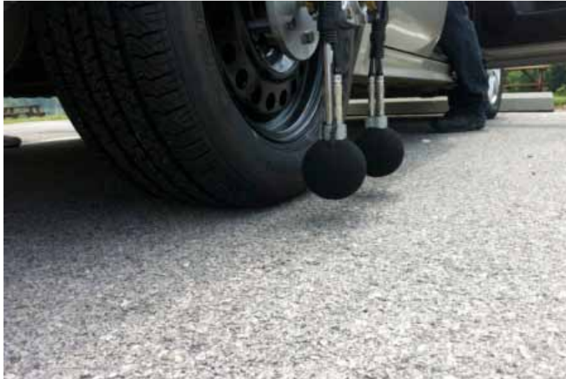
Fig.20.Detalle de micrófonos de sistema OBSI
