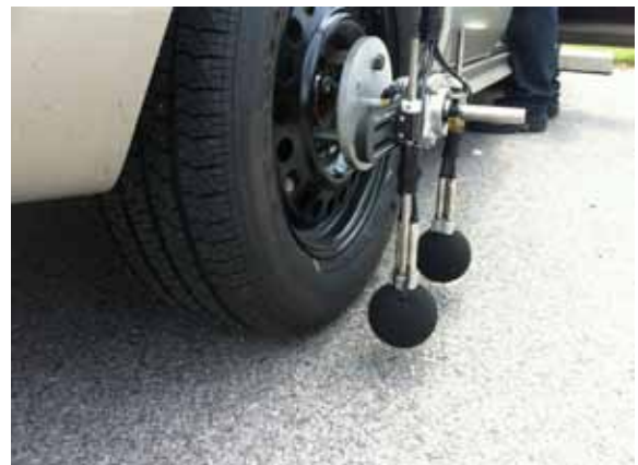
Fig. 19. Sistema OBSI desarrollado por AVEC, Inc.
