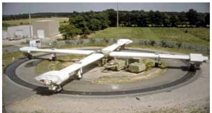
Figura 1. Carrusel para estudio de la fatiga en los pavimentos, LCPC Francia. 6
