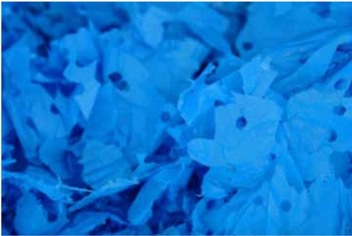
Figura 3. Material de bolsa preparado para incorporación al asfalto
