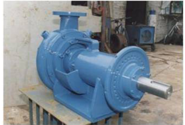
Fotografía 1. Molino homogeneizador (tipo trigonal) empleado en la incorporación de los polímeros (recomendado para elastómeros SBS). Capacidad de producción de 30 a 40 toneladas por hora.
