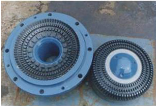
Fotografía 1. Molino homogeneizador (tipo trigonal) empleado en la incorporación de los polímeros (recomendado para elastómeros SBS). Capacidad de producción de 30 a 40 toneladas por hora.
