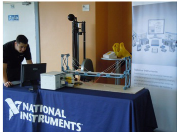
Figura 2. Estructura a escala reducida con diferentes de presión y deformación sensores para monitoreo en tiempo real.
