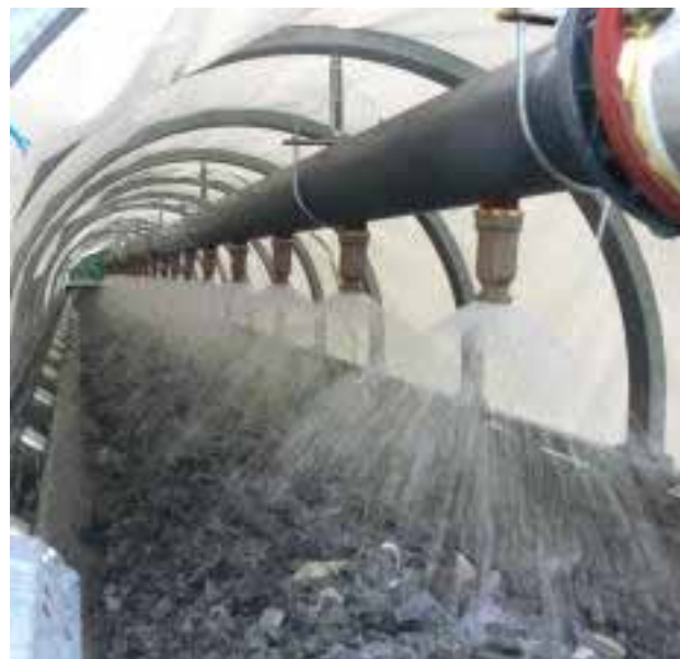
Figura 5. Enfriado de agregados mediante agua Fuente: Ocmer Impianti
