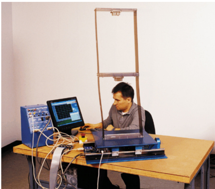
Figura 1. Ensamblaje de la mesa vibratoria Shake Table II para la realización de experimentos
