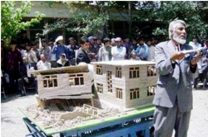
Figura 3. Demostración de mejores técnicas constructivas con una mesa vibratoria portátil en la conferencia SismoAdobe2005 en Lima, Perú
