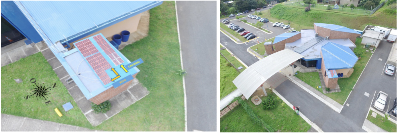
Figura 1. Vista aérea de las muestras de asfalto instaladas en el techo del CTT
