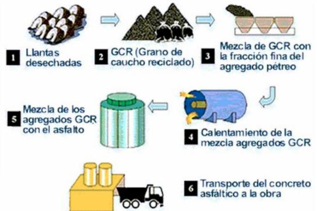
Figura 6. Proceso de adición del caucho por vía seca.
