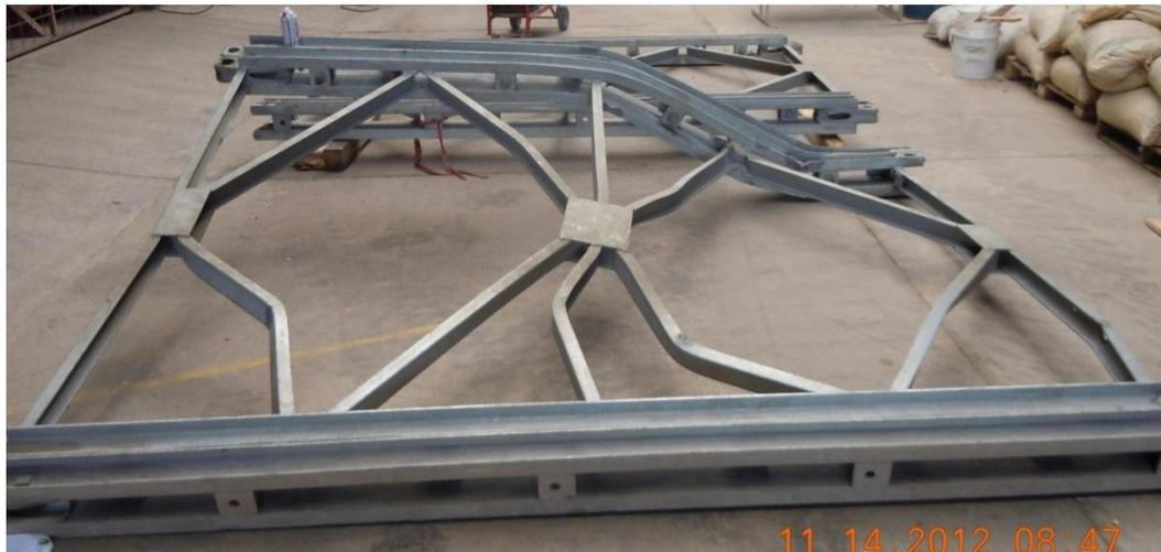
**Figura 3.** Panel modular utilizado para extraer los especímenes de acero a utilizar en los
