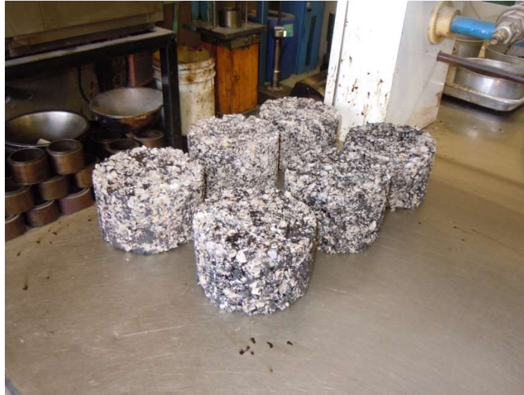
Figura 9: Especímenes compactados en laboratorio con mezcla hecha por máquina
