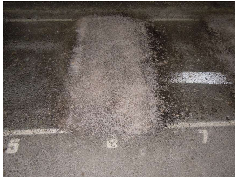
Figura 17: Baches evaluados en la pista experimental del HVS
