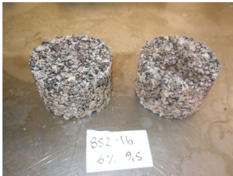
Figura 11: Especímenes hechos con mezcla realizada en laboratorio con agregado M-0852-16
