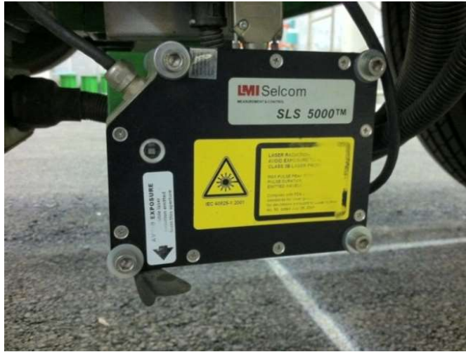
Figura 4: Perfilómetro láser (Camacho & Leiva, Proceso Constructivo Pavelab, 2014)
