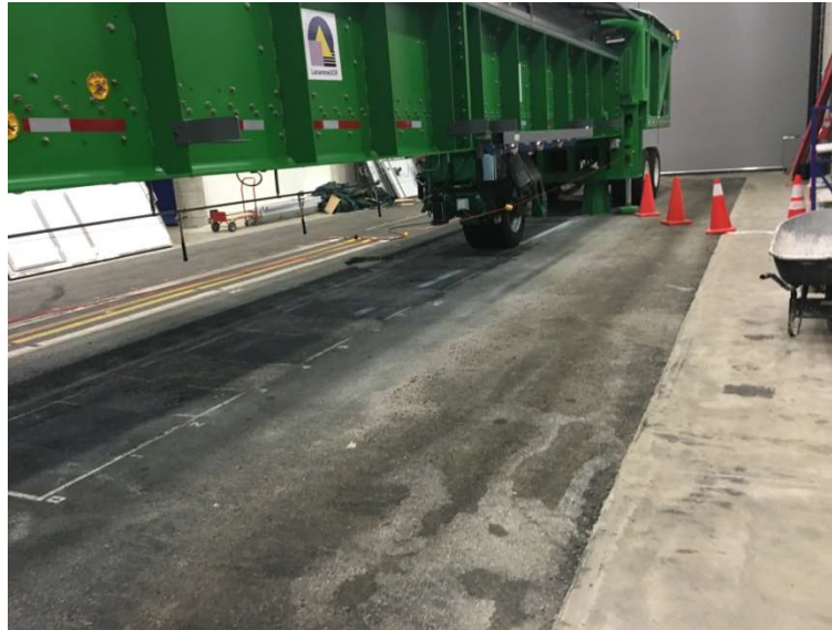
Figura 16: Evaluación de baches con HVS en la pista de pruebas del PaveLab
