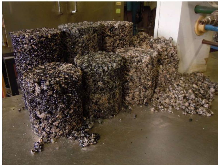
Figura 10: Especímenes que han perdido integridad durante el proceso de curado a temperatura ambiente
