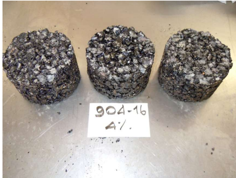
Figura 12: Especímenes realizados con mezcla hecha en laboratorio con agregado M-0904-16
