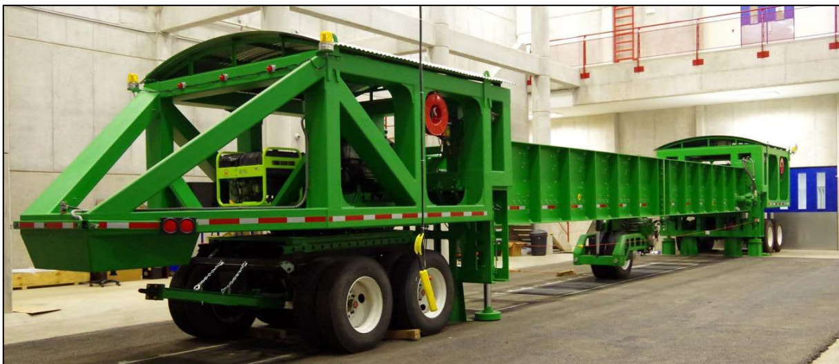
Figura 3. Simulador de Vehículos Pesados, HVS Mark VI de Dynatest.
