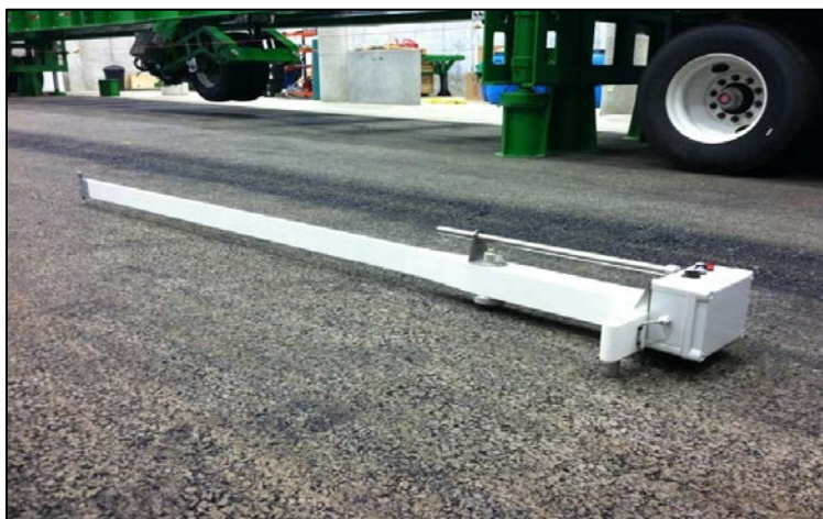
Figura 7. Deflectómetro de superficie del pavimento.
