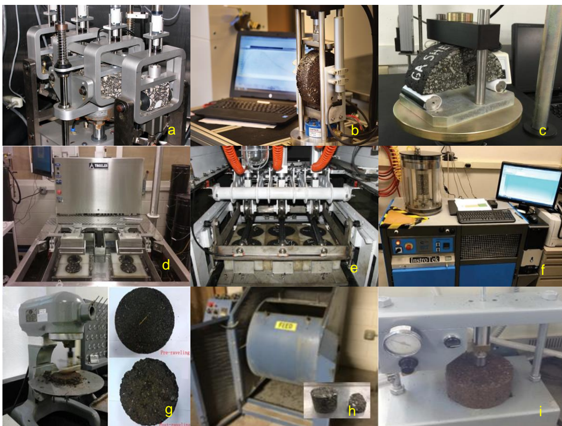
Figura 5. Ensayos de desempeño en MAF: a) viga a fatiga, b) Ideal-CT, c) viga semicircular, d) rueda de Hamburgo, e) APA, f) Flow number, g) desprendimiento, h) Cántaro e i) cohesión
