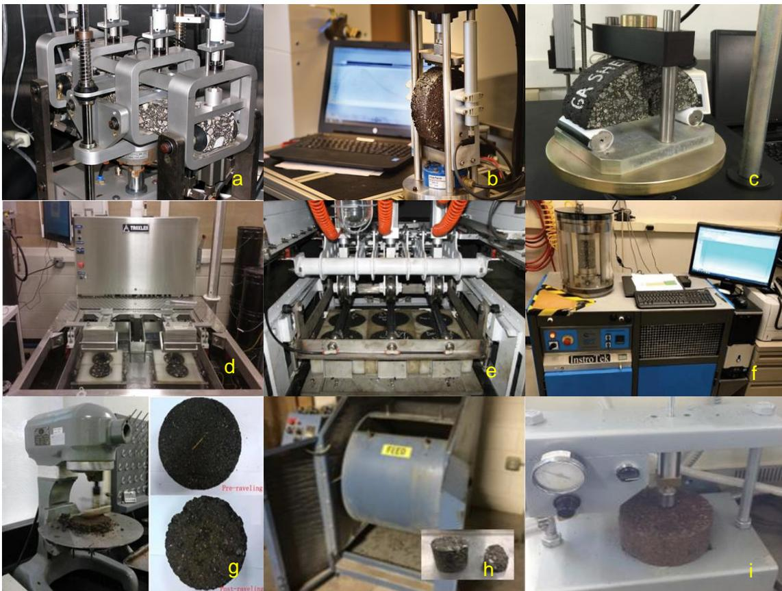
**Figura 2.** Ensayos de desempeño en MAF: a) viga a fatiga, b) Ideal-CT, c) viga semicircular, d) rueda de Hamburgo, e) APA, f) Flow number, g) desprendimiento, h) Cántaro e i) cohesión
