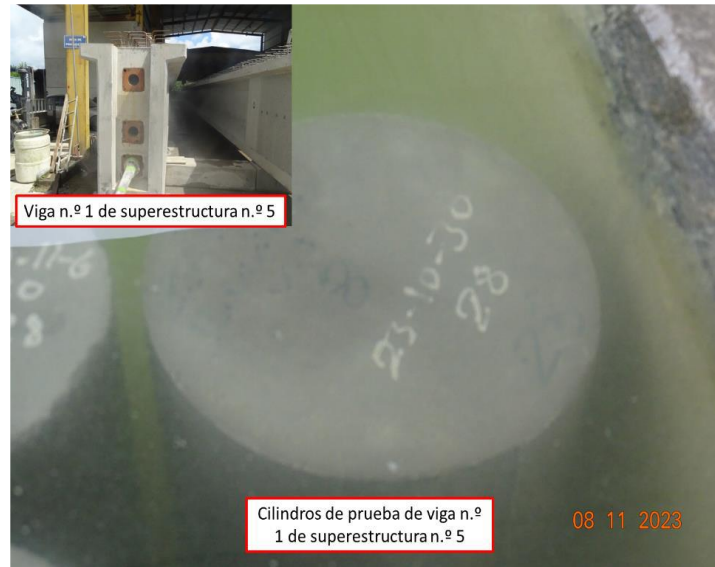
Figura 34. Cilindros de concreto en pileta de curado. Fecha: 8 de noviembre de 2023. Fuente: LanammeUCR
