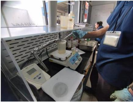
7. Para que la fase jabonosa preparada no pierda temperatura, tapar el beaker con papel aluminio y colocar en un horno a 50 °C por al menos 10 minutos antes de fabricar la emulsión.
