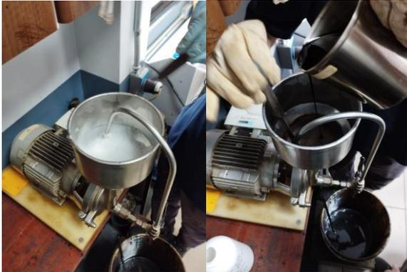
10. Después de vertido el asfalto, accionar el cronómetro para medir el tiempo de molienda y recircular la emulsión por 10 s, posteriormente, abrir la válvula de salida para verter la emulsión en el recipiente de almacenamiento. Detener el tiempo del cronómetro cuando se apague el molino.
