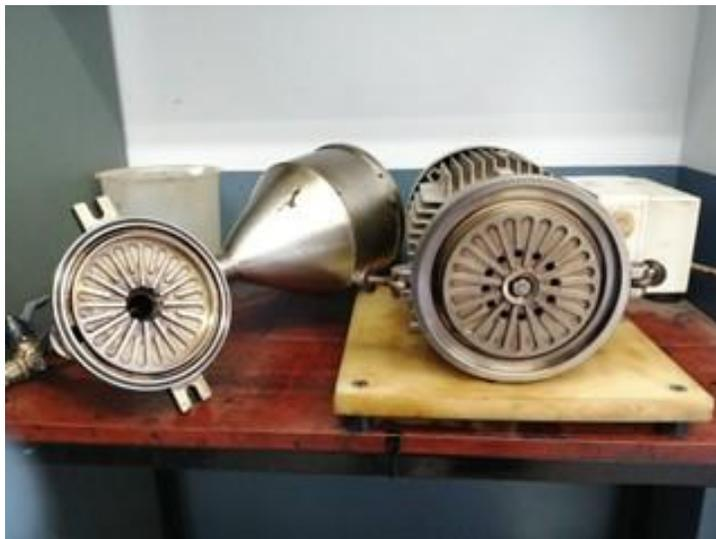
En el transcurso de la investigación se comprobó que se requiere un molino coloidal de alta energía de corte para obtener distribuciones de tamaño partícula más angostas y uniformes, así
