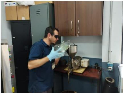
9. Una vez acondicionado el molino, agregar la solución jabonosa, encender el molino, inmediatamente el asfalto del horno, tarar la balanza con el recipiente con asfalto, y verter en la tolva del molino lentamente cerca del tubo de recirculación, evitando el vórtice, al
