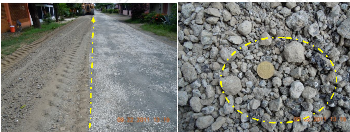
Figura 28: Condiciones del material de recuperación, se aprecia en buenas condiciones de granulometría.
