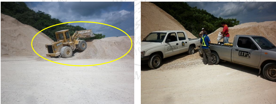
Figura 8: Mejoramiento en el apilamiento en el tajo utilizando terrazas. Muestreo conjunto de agregados para material de base.
