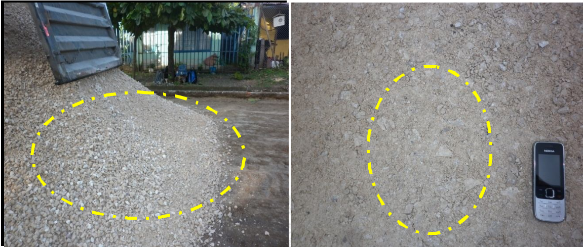
Figura 7: Inconsistencia en cuanto a granulometría en la entrega del material entregado en el proyecto.
