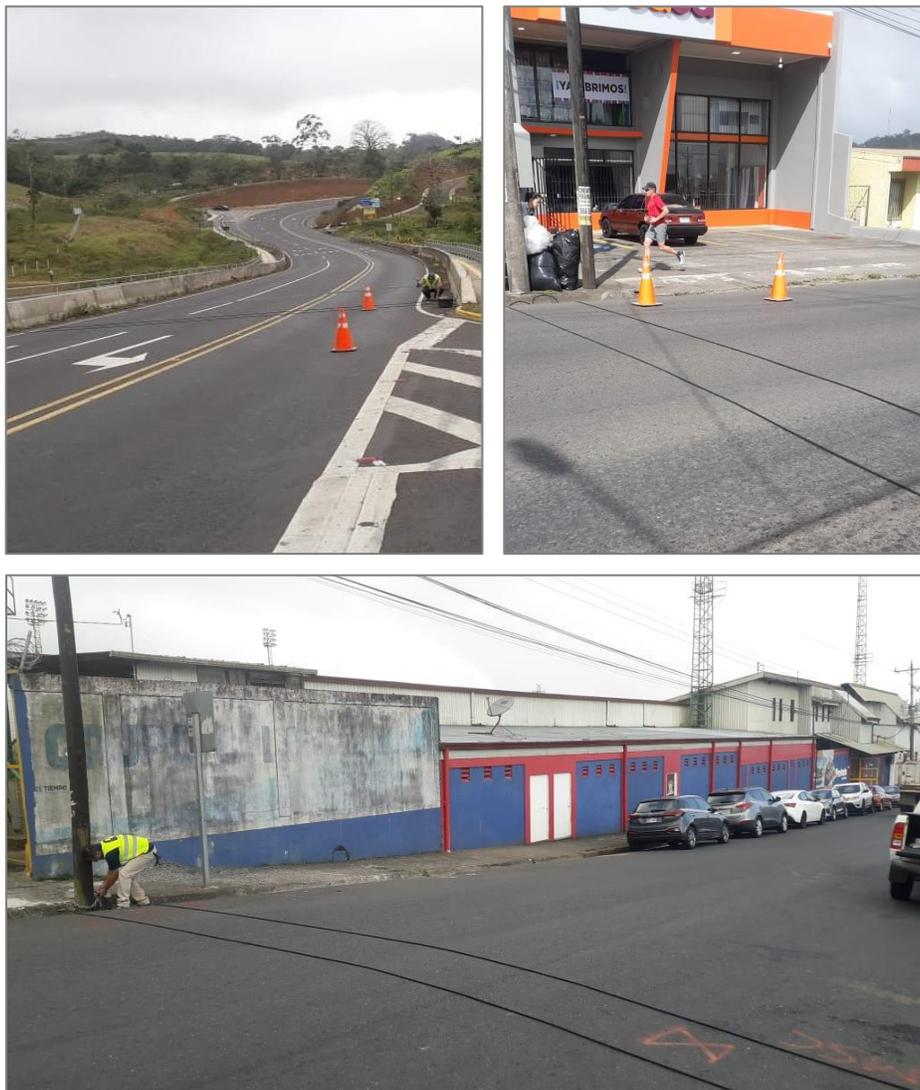
**Figura 2.** Colocación de contadores neumáticos en el cantón de San Carlos
