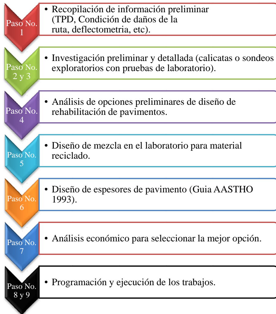
Figura 2. Pasos para la elaboración de proyectos de rehabilitación.
