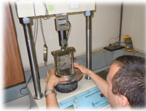
Figura 11. Ensayo de resistencia retenida a la tensión diametral. Fuente: LanammeUCR (2013).
