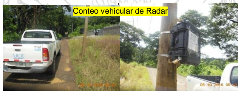
Figura 3. Instalación de contador vehicular automático en el camino.
