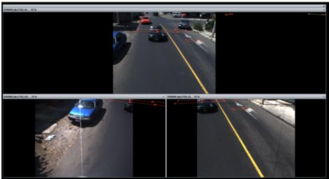
Figura 19. Visualización del procesamiento de datos para el cálculo de PCI.
