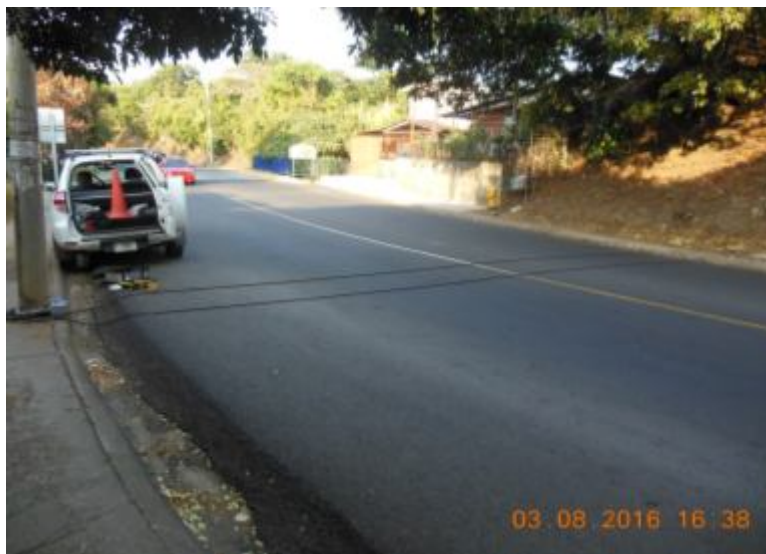
Figura 4. Contadores automáticos en red vial distrito Mercedes. Fuente: LanammeUCR.
