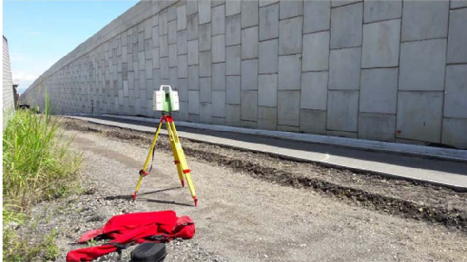
Figura 1 Escáner LIDAR terrestre utilizado en el levantamiento de los muros de relleno reforzado del paso a desnivel Firestone
