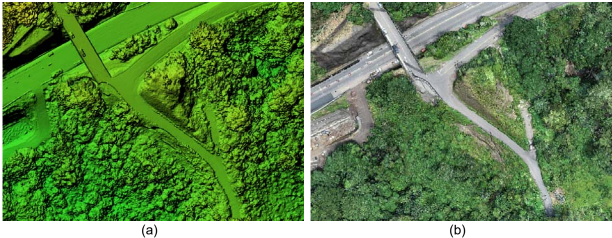
Figura 4. Resultados obtenidos del levantamiento realizado con un Vehículo Aéreo No Tripulado (VANT) de la zona de estudio (a) Modelo digital de superficie (b) nube de puntos
