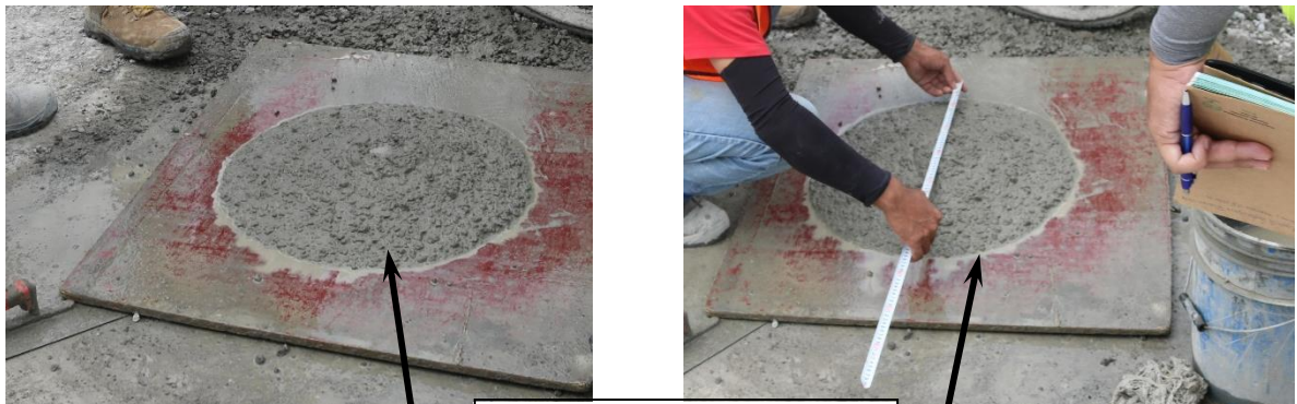
Mezcla no tan segregada. Índice de estabilidad visual según la norma ASTM C1611 VSI=1 (estable)
