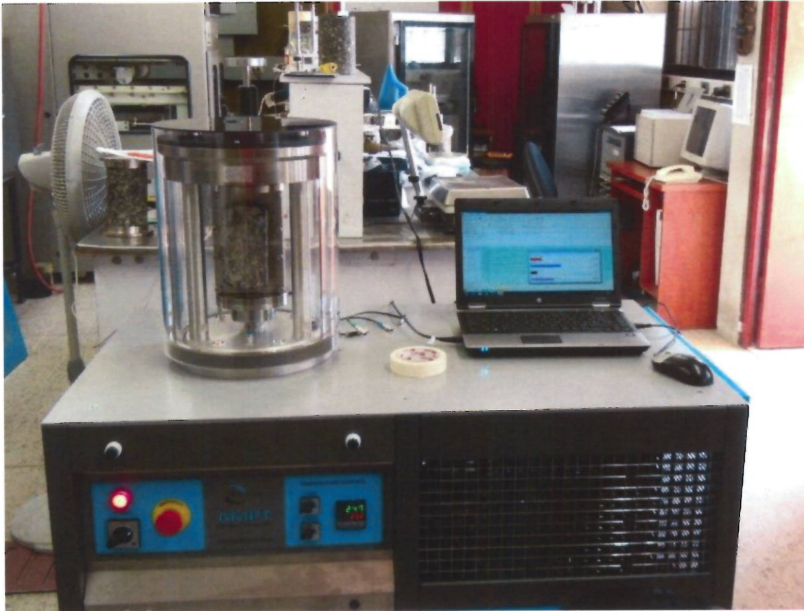
Figura 2. Ensayo de Texas Overlay.
