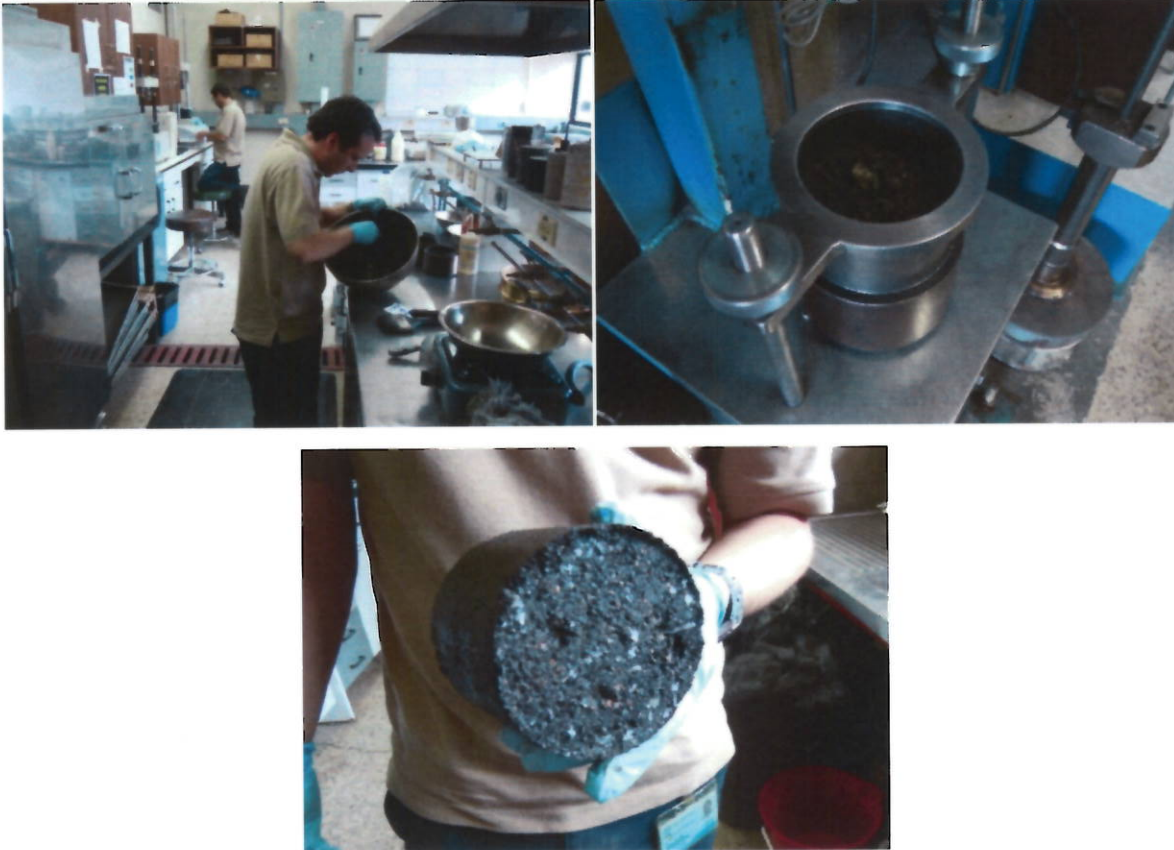
Figura 23. Preparación de especímenes Marshall con material de base estabilizada con emulsión.
