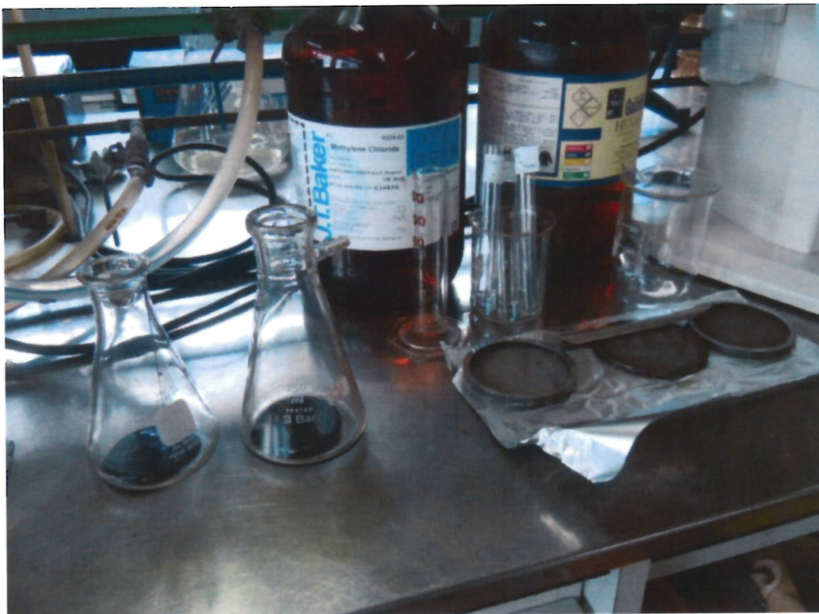
Figura 16. Materiales requeridos para cuantificar la cantidad de SBR adicionada al asfalto
