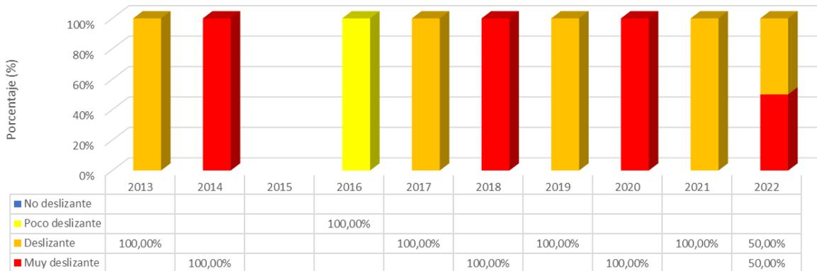
Figura 45. Comparativo Coeficiente de Rozamiento Superficial (GripTester) Radial Turrúcares 2013-2022
