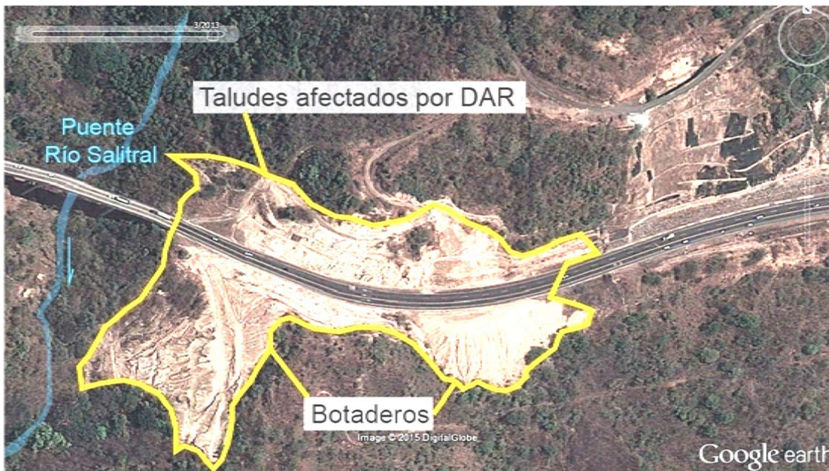
Figura 2. Zonas identificadas con afectaciones producidas por el drenaje ácido de rocas (DAR) próximas al estacionamiento 48+000 en el año 2016 (Fuente: INF-UGERVN-05-2016)
