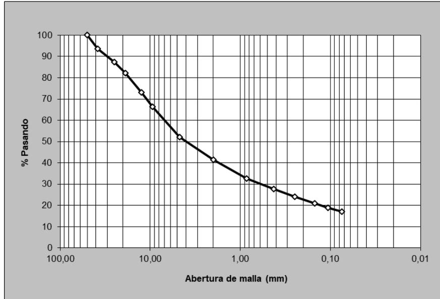
Figura 8. Curva granulométrica, muestra M-1857-2022
