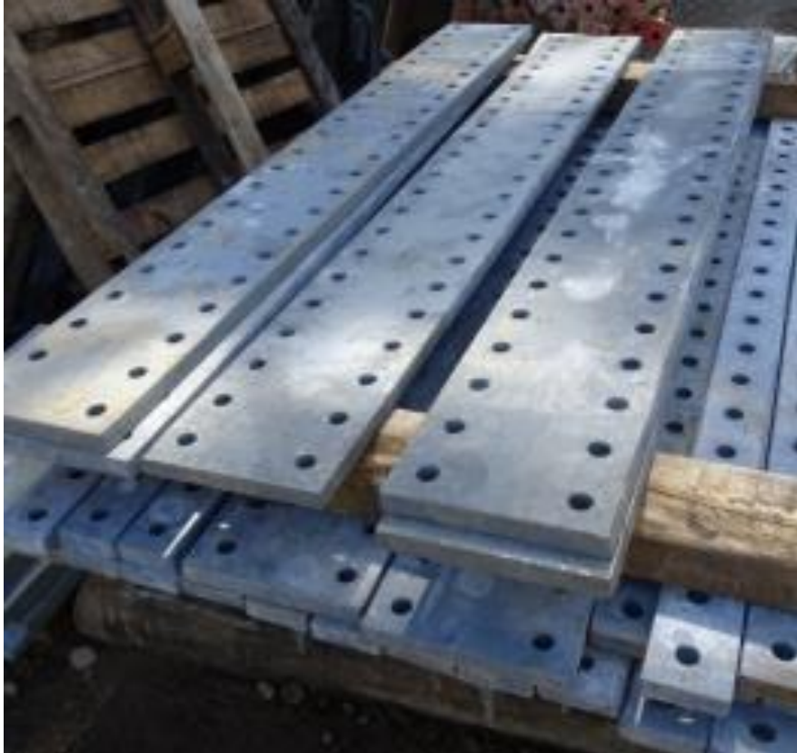
Figura 20. Elementos de unión de viga con bordes filosos para puente sobre río Esperanza. Fecha 17 de agosto de 2022
