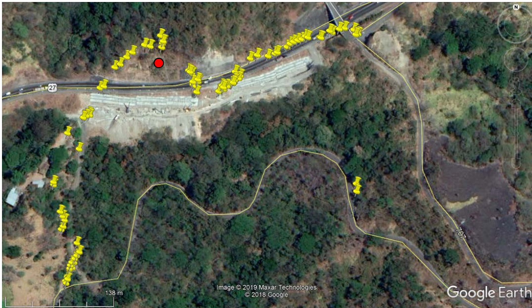
Figura 64: .PK 44+500. Las marcas amarillas muestran el recorrido de la grieta en la superficie. El punto rojo es la ubicación del monitoreo geotécnico..
