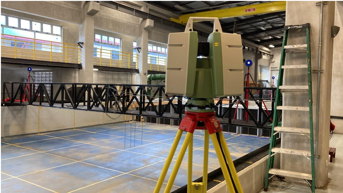
Figura 3 Escáner Leica C10 utilizado en este estudio. Nótese la presencia de una escalinata sobre la pileta.
