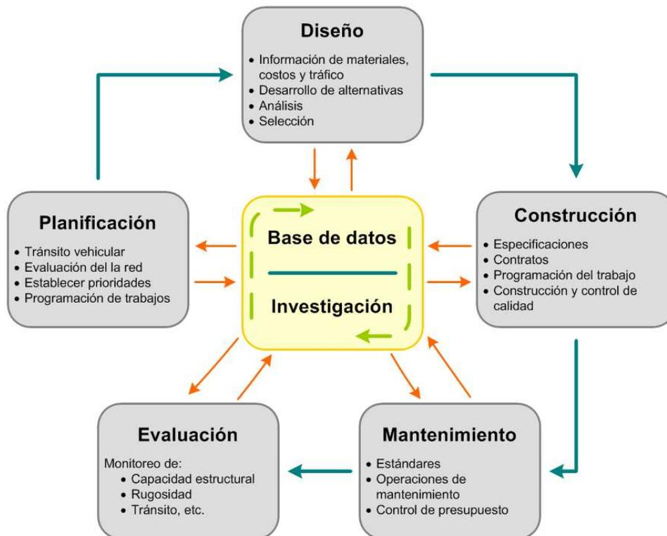
**Figura 1.** Estructura general de un Sistema de Administración de Pavimentos (SAP)
