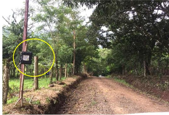
b) Contador radar en vía no
