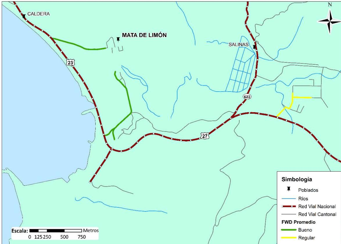
**Figura 64.** Condición estructural (FWD) de la RVC asfaltada del distrito Caldera.
