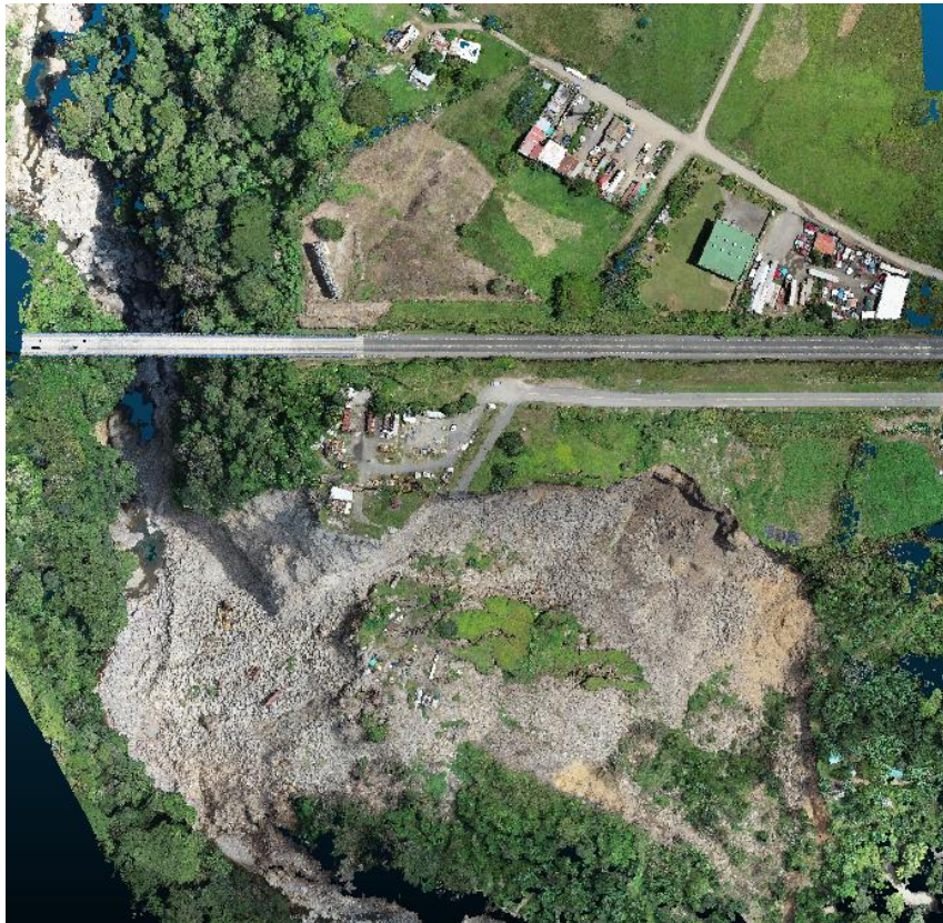
Figura 9. Nube de puntos obtenida de la zona de estudio como resultado del levantamiento realizado con el VANT
