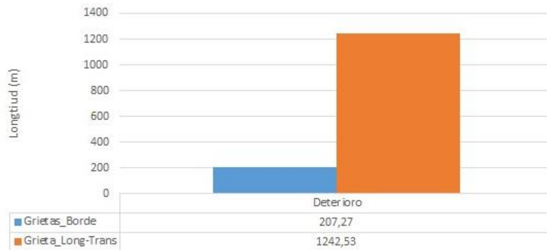
Figura 8: Deterioros por longitud identificados, sección de pavimento flexible
