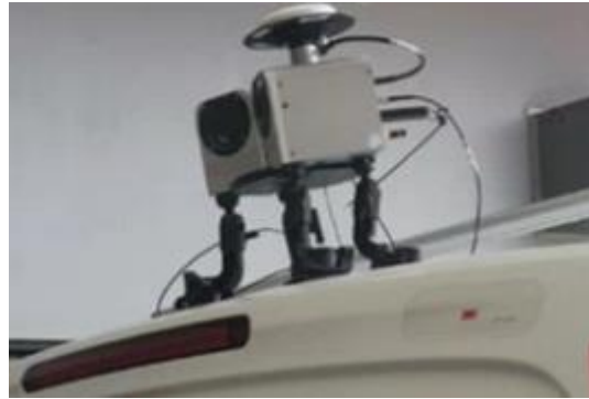
Figura 2: Equipo marca Imajing para el levantamiento fotográfico del tramo
