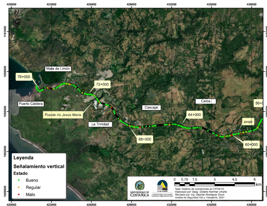
Figura 82. Inventario de señales verticales, RN27, sección 60+000 – 76+000
