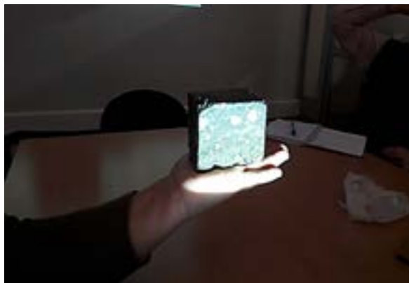
Figura 7. Sello construido en 1995 con varias capas de tratamiento superficial (Región de Valparaíso)
