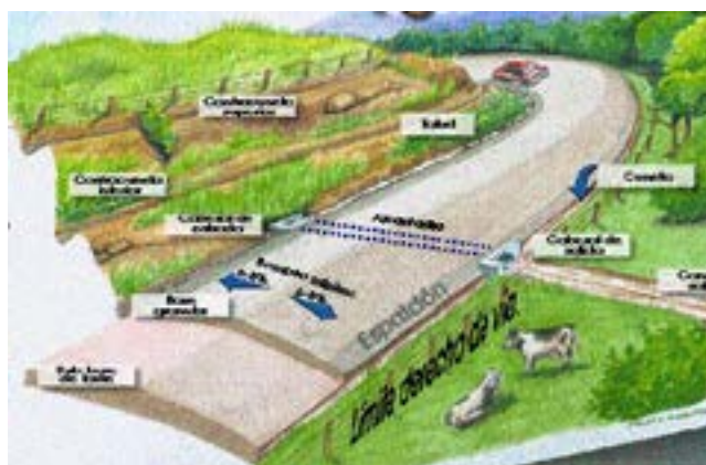
Figura 11. Obras indispensables para el manejo de aguas MOPT-GTZ
