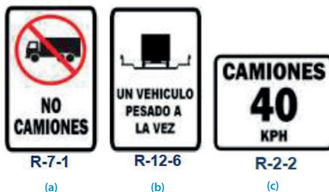
Figura 7. Ejemplos de señalización vertical de reglamentación. (a) Para prohibir el paso de vehículos pesados (SIECA, 2014); (b) Para indicar que solo un vehículo pesado a la vez debe transitar sobre un puente (SIECA, 2014); (c) Para restringir la velocidad del tránsito por un puente (SIECA, 2014).
