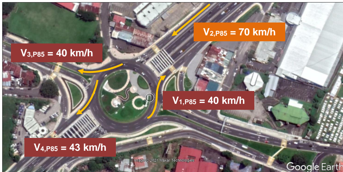
Figura 9. Medición de velocidades de operación ( V_{P85} ) con radares portátiles en 4 puntos.
