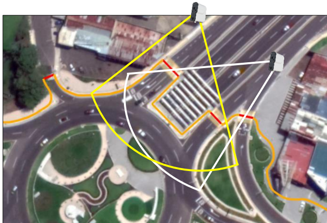
Figura 6. Colocación de cámaras viales y sus ángulos de visión y alcance aproximados.
