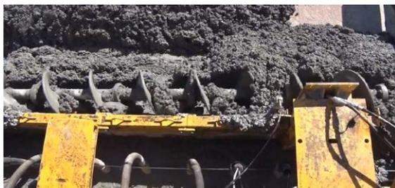
Figura 30. Sistema de vibradores internos del equipo de pavimentación de encofrados deslizantes
