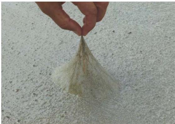
Figura 40. Membrana de curado formada con productos químicos
