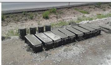
Figura 58. Muestras de concreto (cilindros y vigas) para la realización de ensayos de laboratorio
