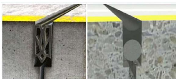
Figura 47. Sellos para juntas en pavimentos de concreto
