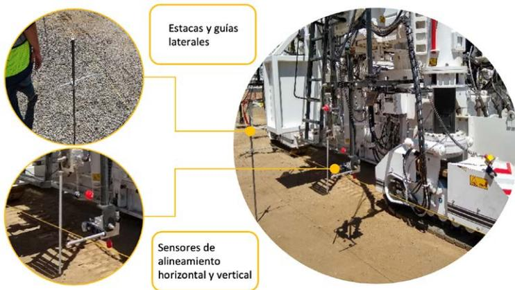
Figura 26. Guías laterales y sensores de alineamiento de la máquina pavimentadora
