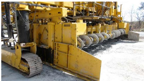
Figura 29. Sistema de reparto del concreto mediante tornillo sinfín
