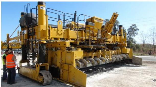
Figura 25. Equipo de encofrados deslizantes para pavimentos de concreto hidráulico
