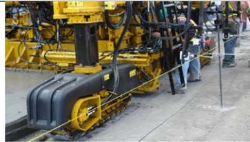
Figura 56. Ubicación adecuada de estacas e hilos guía
