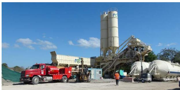
Figura 17. Planta de producción de concreto
