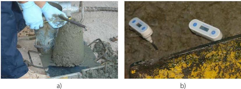
Figura 18. Control de asentamiento (a) y temperatura (b) del concreto en sitio de descarga
