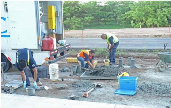
Figura 50. Muestreo de concreto para ensayos en laboratorio
