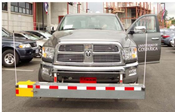
Figura 51. Perfilómetro láser
