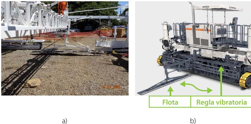
Figura 31. Alisadores de equipo de encofrados deslizantes
