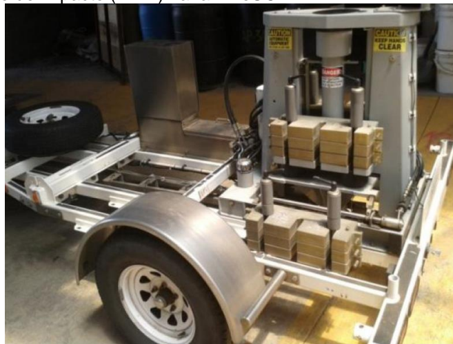
Figura 9. Deflectómetro de impacto (FWD) LanammeUCR
