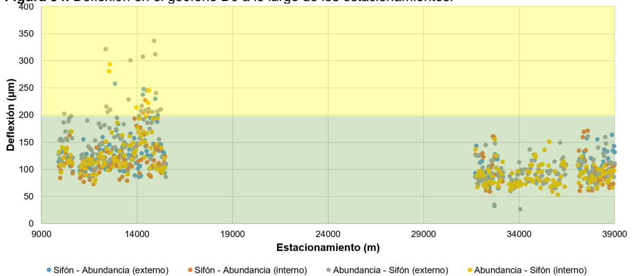
Figura 34. Deflexión en el geófono D0 a lo largo de los estacionamientos.
