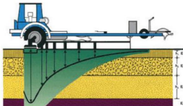
Figura 10. Ilustración curva de deflexiones generada ensayo deflectometría (FWD)
