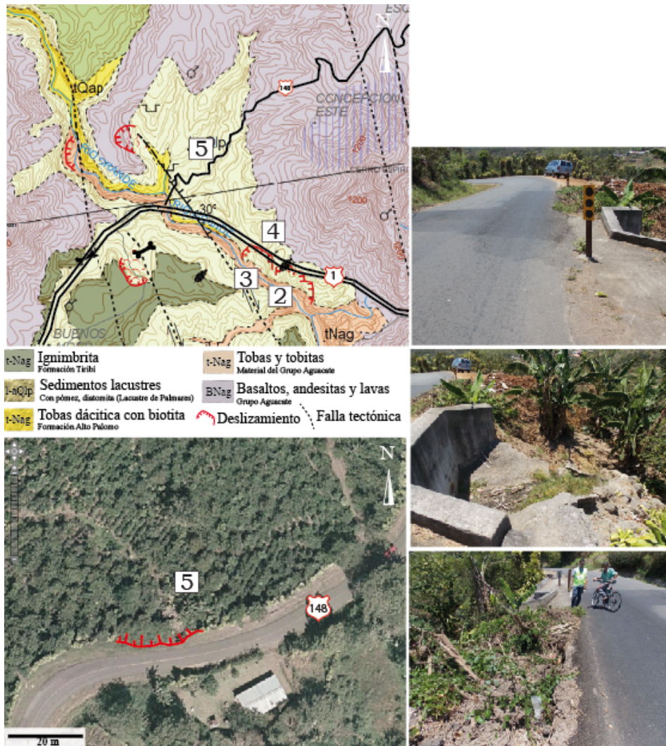
Figura No.14 Se muestra la relación del deslizamiento del punto 5, con la unidad de Sedimentos Lacustres Palmares. Una fotografía aérea donde se muestra la ubicación de la corona del deslizamiento con respecto a la carretera y tres fotografías tomadas en el sitio, donde se muestra la afectación en la capa asfáltica y como actualmente se están depositando clandestinamente escombros y material en la zona del deslizamiento, generando un problema mayor.
